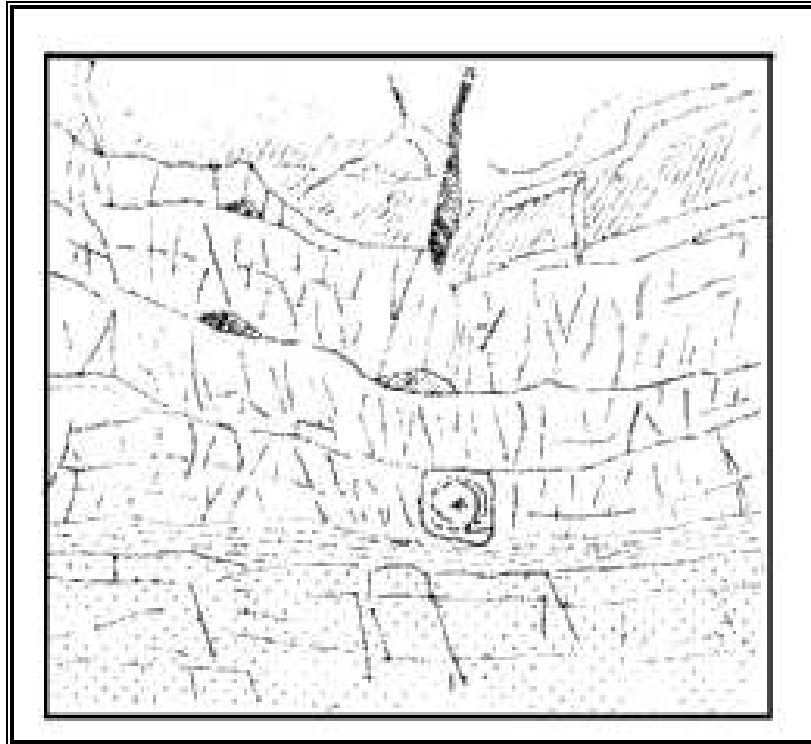
Fig. 94 – Différences et comportement de 03 niveaux gréseux voisins, face à la fracturation
