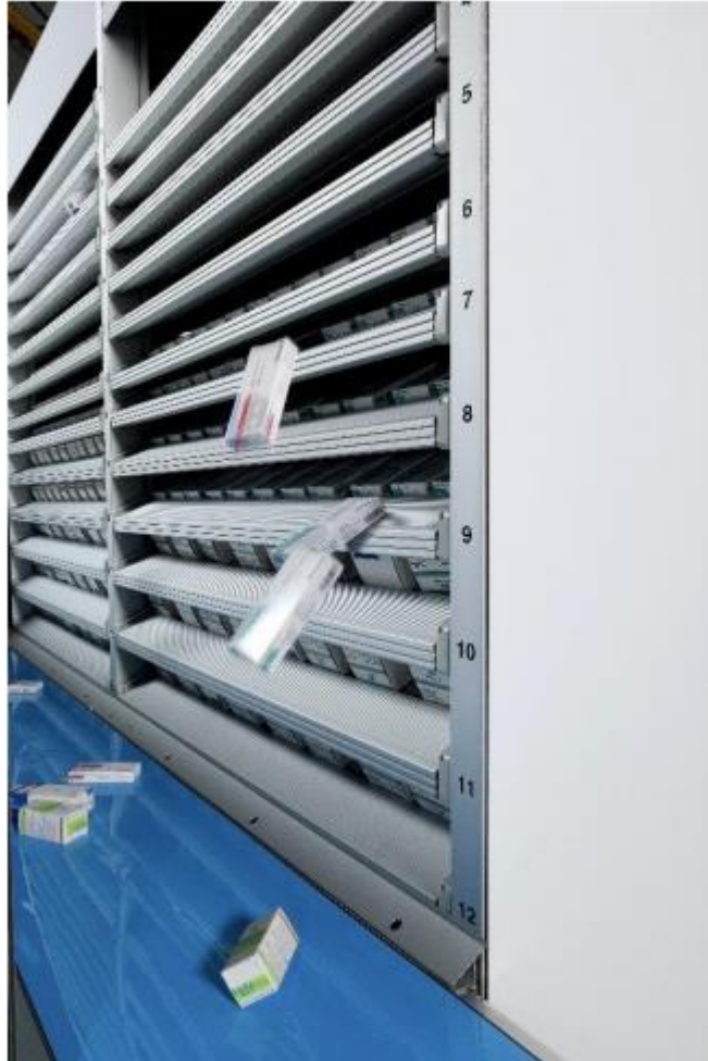
Figure 2.1. Photo réelle d'un flow-rack AS/RS à chute libre « APOTEKA ».
