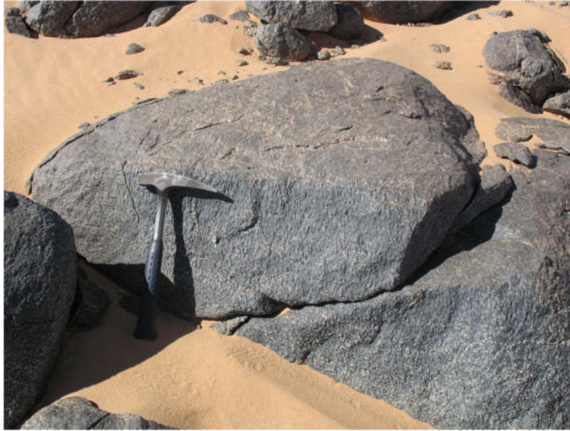
Photo 3 : Affleurement de la diorite TM26 prise à l'ouest d'oued Tin Amzi. L'aspect massif, la couleur dans les tons grisâtres et les taches blanchâtres dues à la présence de feldspaths sont bien illustrés.
