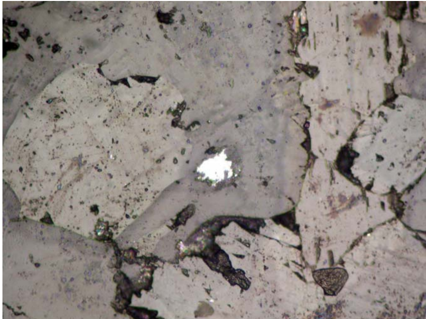
Photo 13 : Section de magnétite (au centre de la photo) incluse dans un feldspath d'une syénite pyroxénique ( échant. EG 41 ). (Vue en L.R., 50 x)
