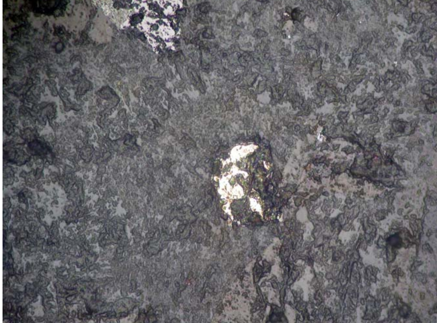
Photo 3 : Section interstitielle de sulfure dans la dolérite.
