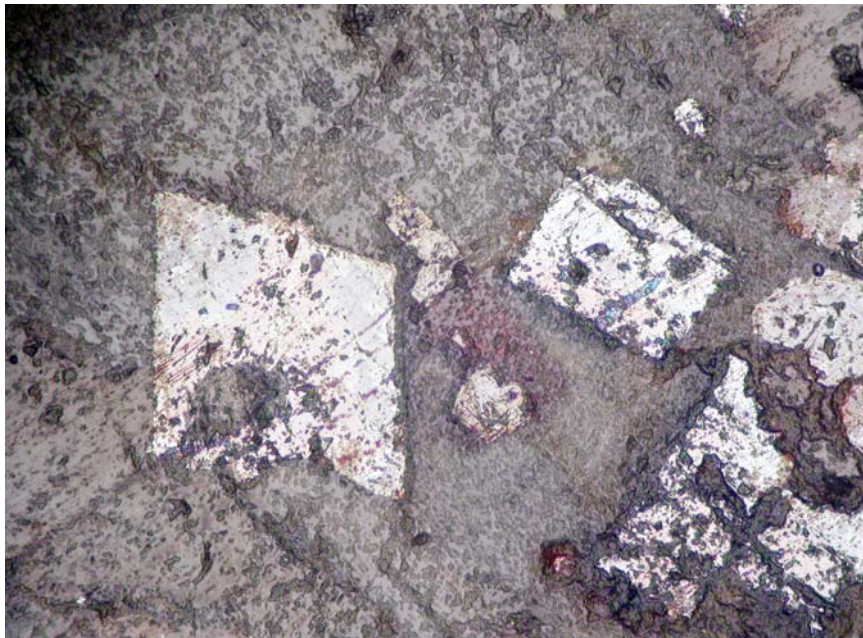
Photo 2 : Cristaux automorphes de magnétite inclus dans un clinopyroxène de la dolérite. (Vue en L.R., 50 x)
