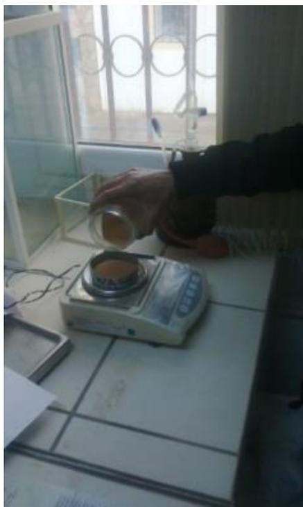
**Tableau N°A05 : Le processus d'analyse de particules granulaires.**
