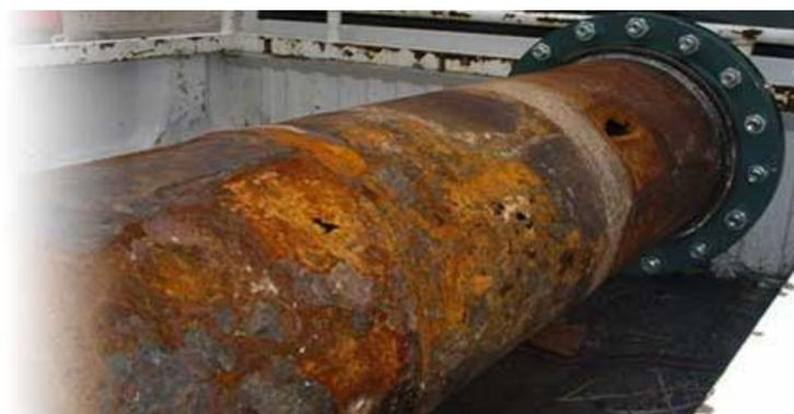
Figure I.9 : Corrosion dans la pipe.
