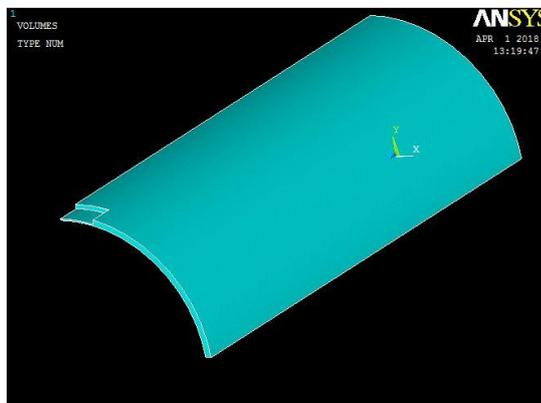
Figure IV.5 : Géométrie d'un pipe avec défaut.
