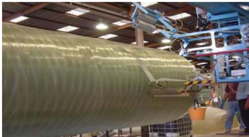
Figure (1-5): Procédé de fabrication par enroulement filamentaire.
