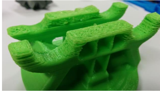
Figure III-72 : Densité d'extrusion faible
