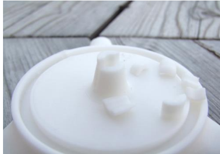
Figure III-74 : Couches mal soudées
