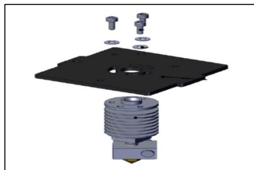
Figure III-58: Démontage du dissipateur de chaleur
