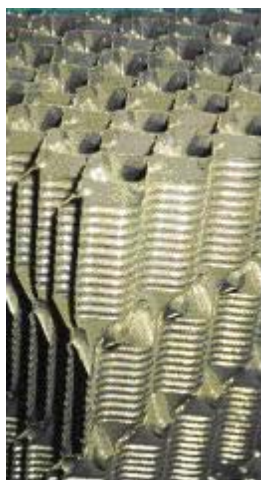
Photo.5. Corps d'échange avec Canaux verticaux. [2]
