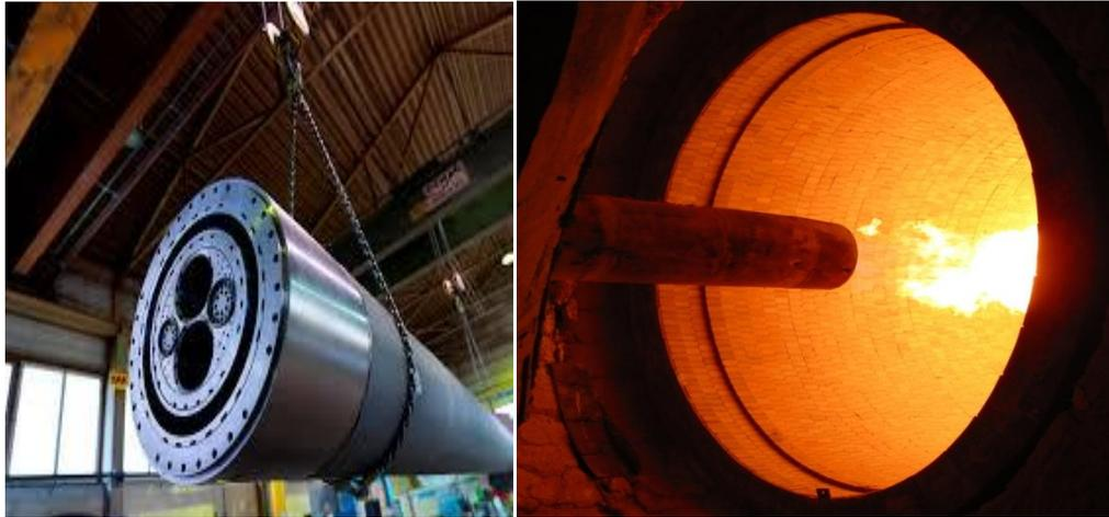
Figure I.16 : Brûleur du four rotatif de ciment LAFARGE.
