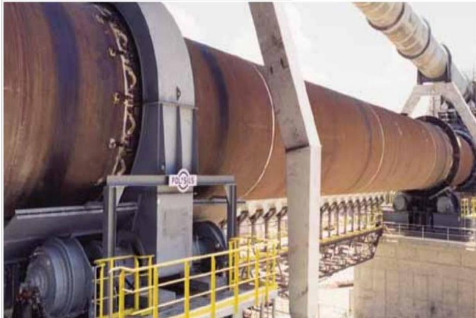
**Figure I.2 :** Four rotatif de cimenterie
