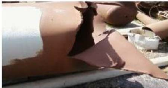
Figure I.11 : Rupture d'un pipeline [5]
