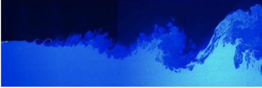
Figure III-1: Visualisation expérimentale d'instabilités de Kelvin-Helmholtz dans une couche de mélange turbulente réalisée par Parezanovic V. dans le cadre du projet TUCOROM à l'institut PPrime (Poitiers, France).
