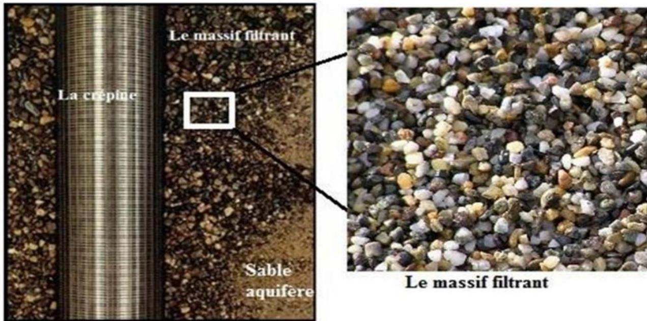
**Figure.33 : Emplacement du massif filtrant dans le forage.**
