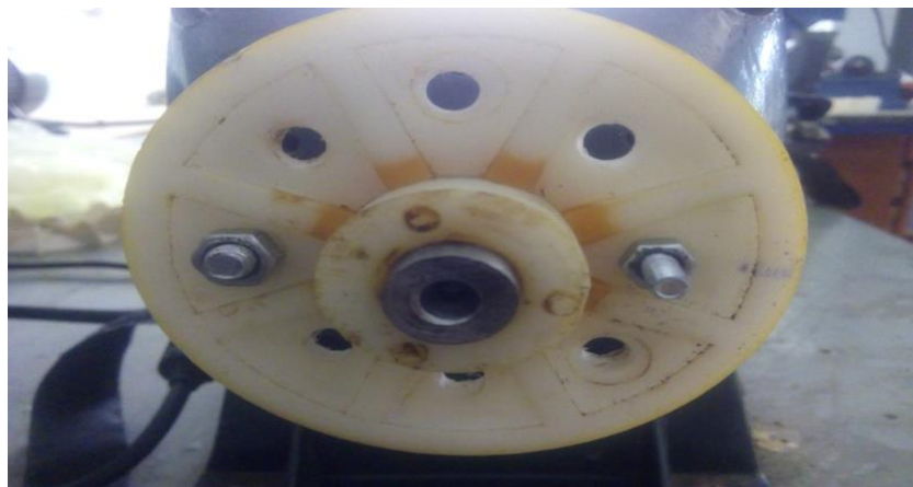
Figure IV.3.9. Masse de correction à 180^0 plan 1
