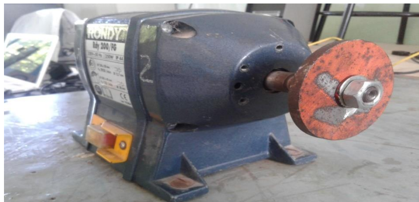
Figure IV.3.3. Montage du disque en acier sur le plan 2
