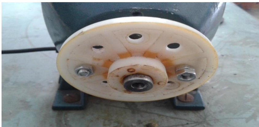
Figure IV.3.8.Masse de correction à 180° plan 1
