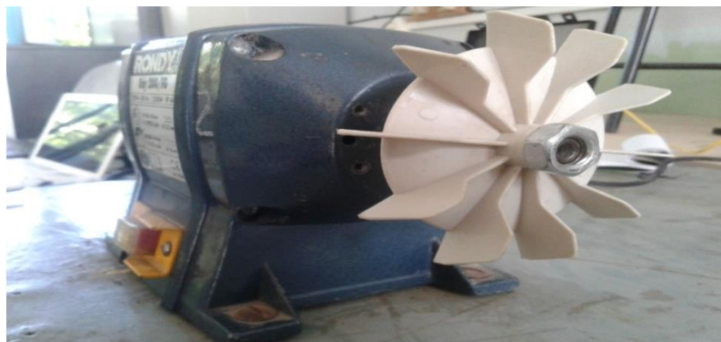
Figure IV.3.4. Montage de ventilateur à sur le plan 2
