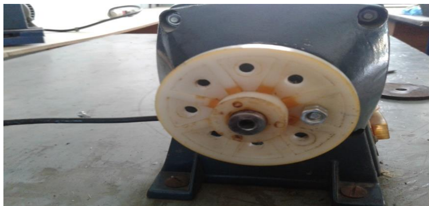
Figure IV.3.7. Création de balourd (essai 2) plan 1
