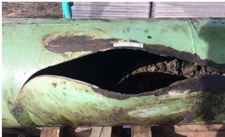
**Figure 2- 2 :** Rupture de tuyaux due à la fissuration par fatigue
