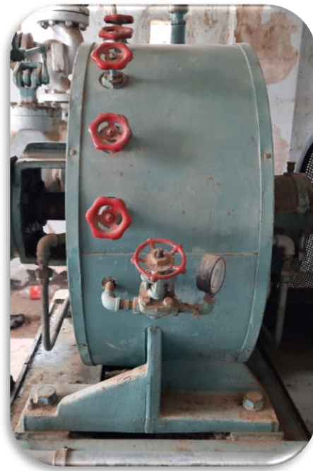
Figure II.8. Schéma décrivant la turbine coppus
