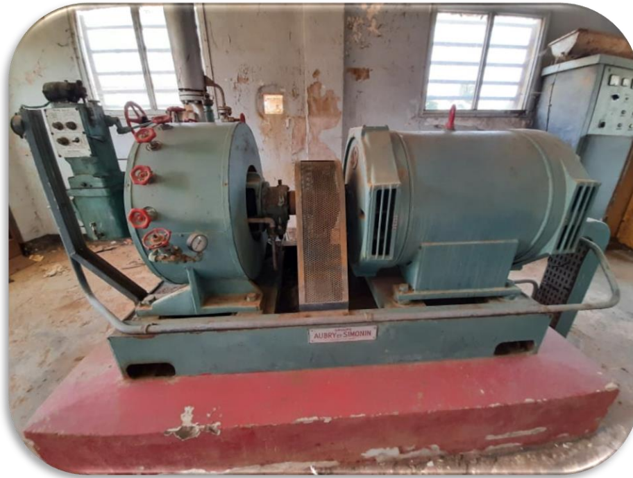
Figure II.11. Schéma décrivant du groupe turbo-alternateur.
