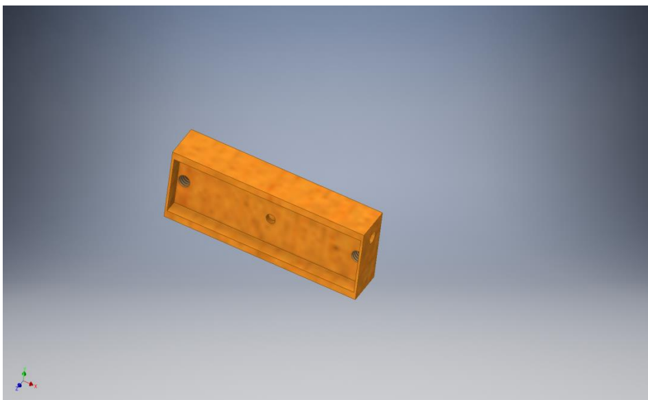
Figure 3.5 : Modélisation 3D du support de l'axe Y
