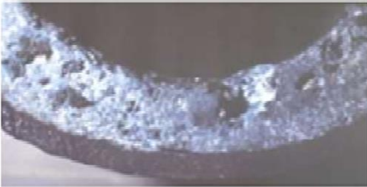
Figure I.11 Dépôt de forte épaisseur dans un tube de surchauffeur de Chaudière MP
