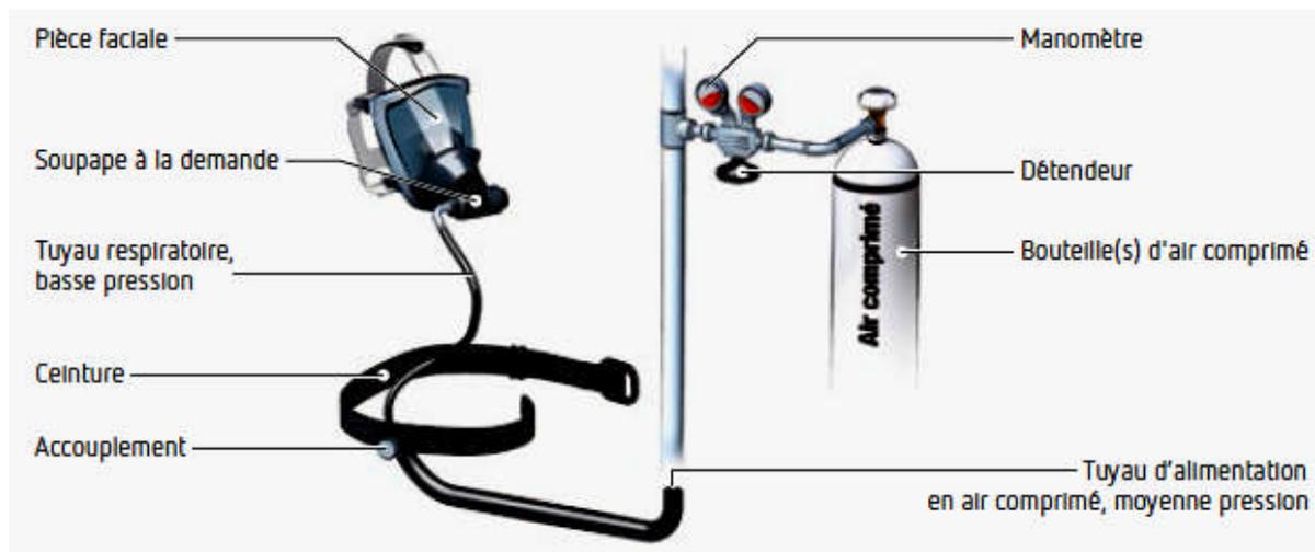
Figure II.17 Appareil respiratoire isolant à adduction d'air comprimé (Autonome).
