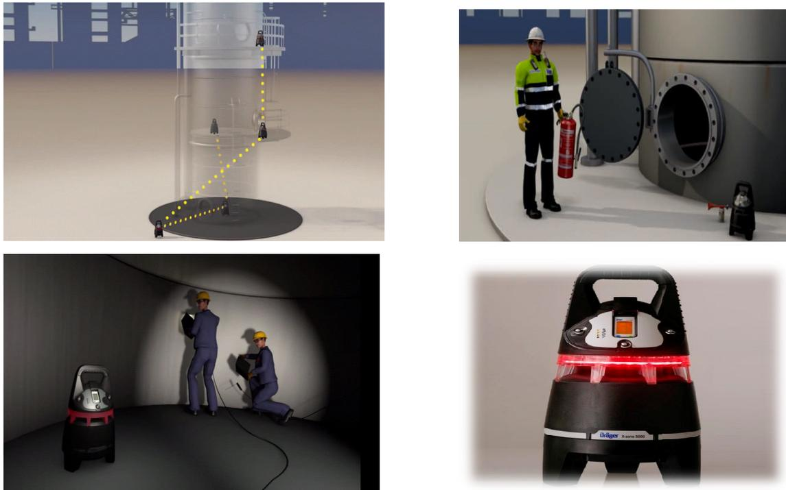
**Figure IV.7** Système de balise de détecteur multi-gaz.
