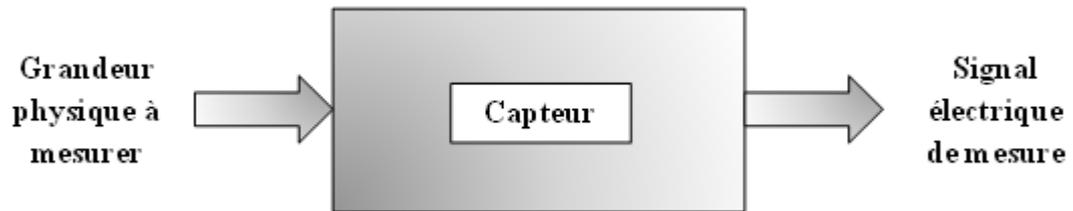
Figure II. 6. Capteur de mesure vibratoire.
