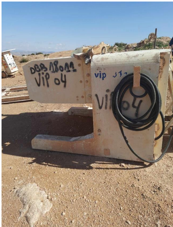
Photo 31 : la machine fil diamanté de la marque vip marque gamma
