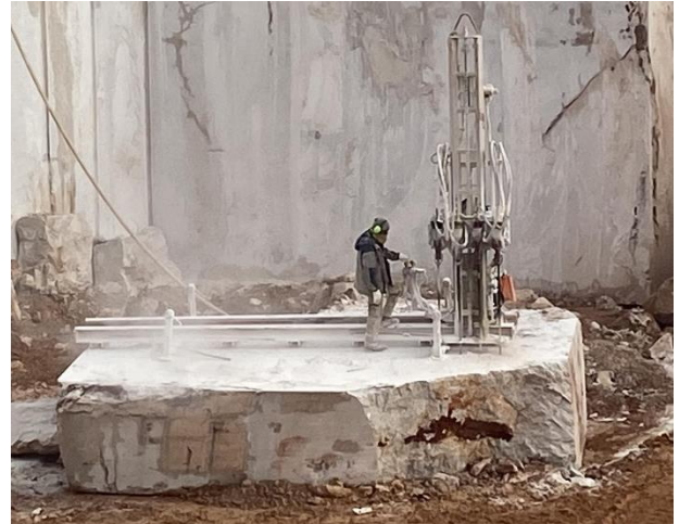
Photo 26 : tranchage verticale avec multi perforateur
