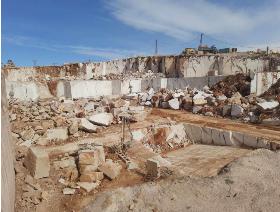
Photo 22 : photo panoramique du site d'exploitation avec les différents gradins
