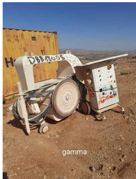
photo 32 : la machine fil diamanté de la marque gamma
