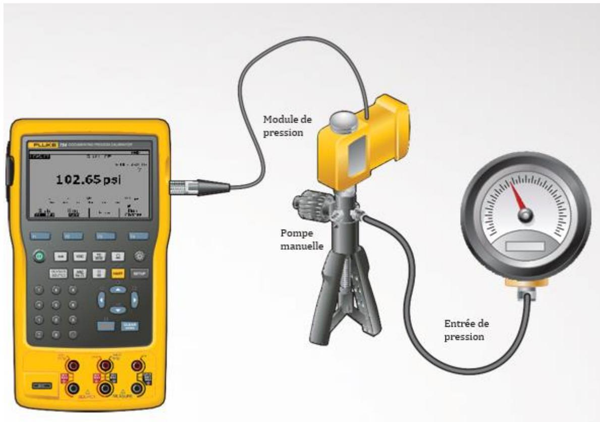
*Figure III.8* Le montage simplifié d'étalonnage d'un manomètre
