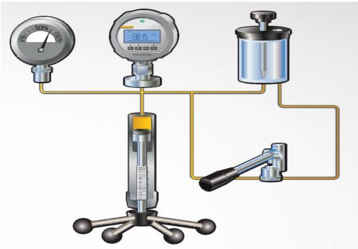
*Figure III.9* Le montage simplifié d'étalonnage d'un manomètre avec comparateur de pression
