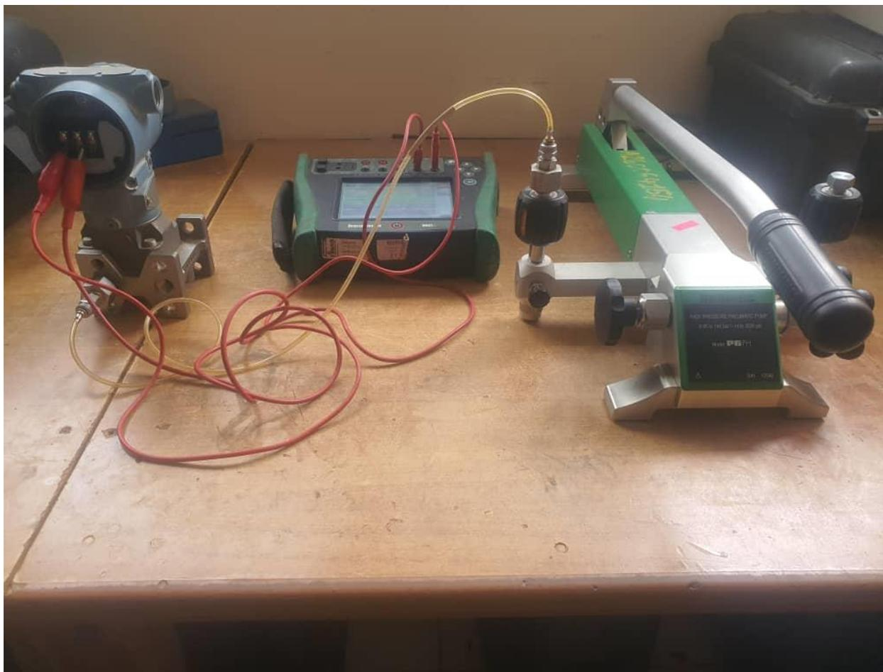
*Figure IV.3* Montage de calibration d'un transmetteur de pression.
