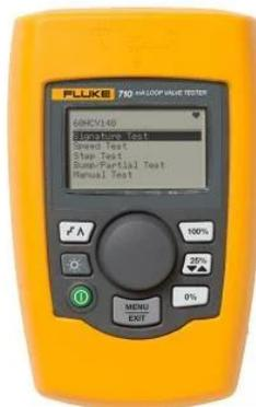
Figure III.13 Testeur de valves de boucle en mA Fluke 710
