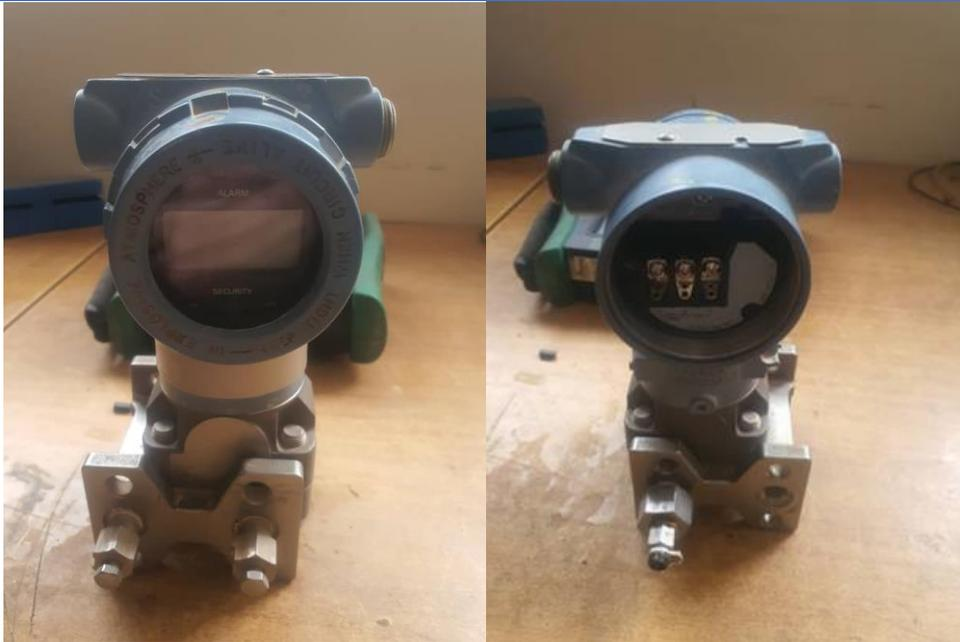
**Figure IV.1** transmetteur de pression modèle EJA110E - Yokogawa
