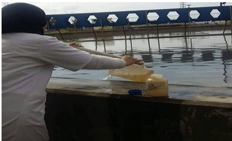
**Photo IV.3:** prélèvement au décanteur primaire
