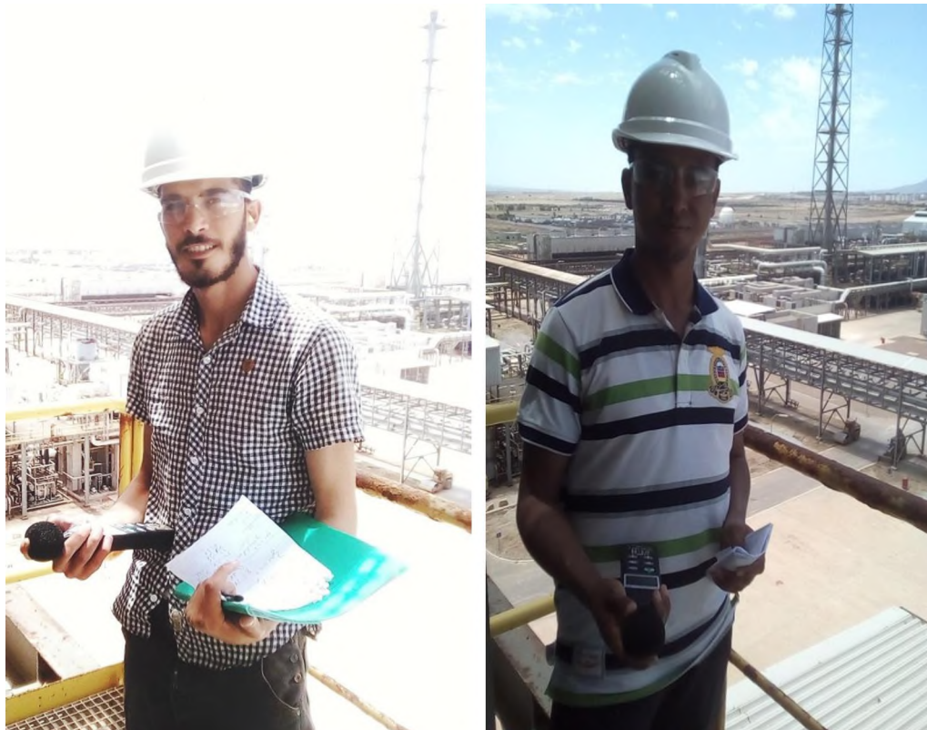
Fig. 24/1 – Prélèvement des échantillons du bruit avec le sonomètre.
