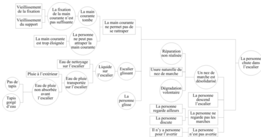
Figure III-2 : Exemple d'arbre des causes pour le cas d'une chute dans un escalier
