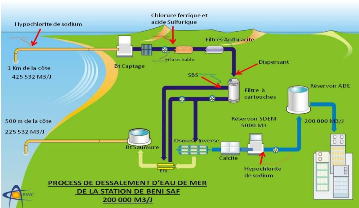
Figure. 12 - Processus du dessalement d'eau de mer de la station
