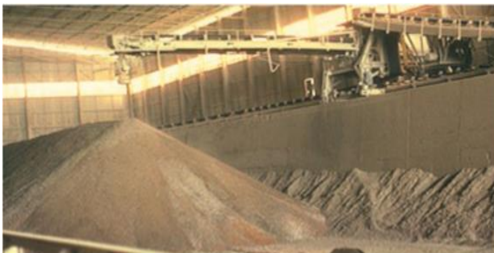
Figure I.5: La pré-homogénéisation par des roues-pelles.
