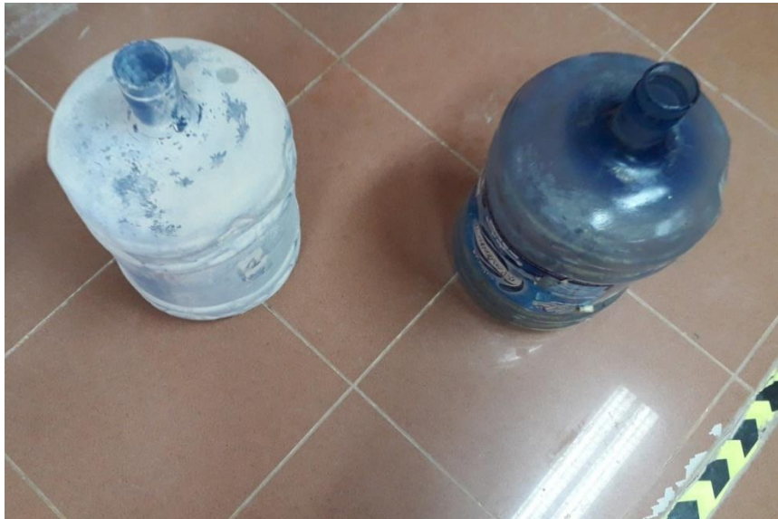
Figure III.5 : récipients de jauge OWN avant et après le nettoyage
