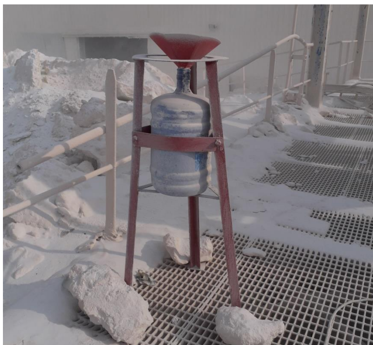
Figure III.3 : Collecteur de type jauge OWN
