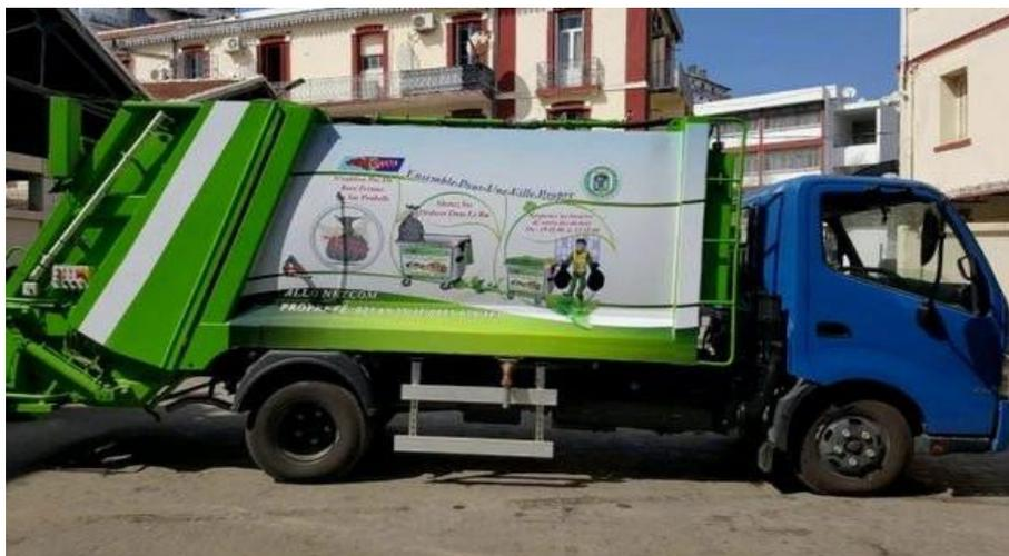
**Fig.I.4 - Collecte déchets ménagers avec camion à benne tasseuse. (APS, 2019)**
