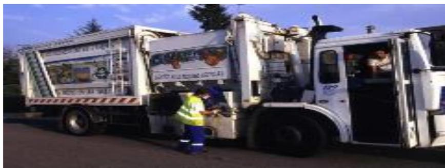
**Fig. I.6 - Benne mixte compartimentée. (www.sytrad.fr)**
