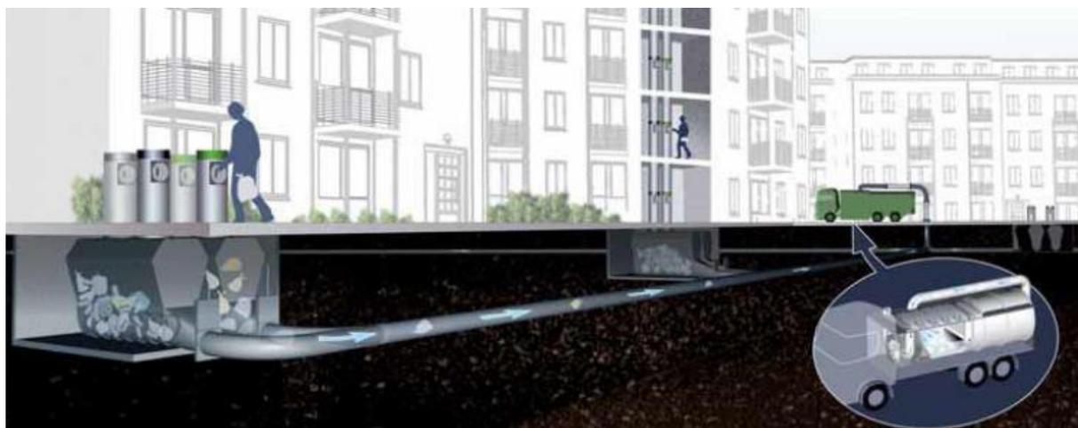
**Fig.I.10- Schéma de principe de la collecte pneumatique des ordures ménagères(Bennama, 2016).**
