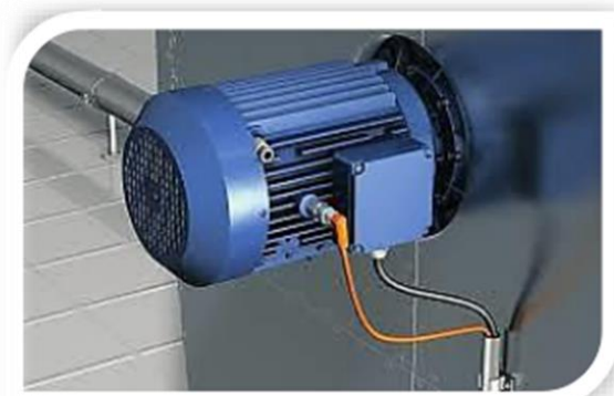
Capteur de vibration monté sur moteur
