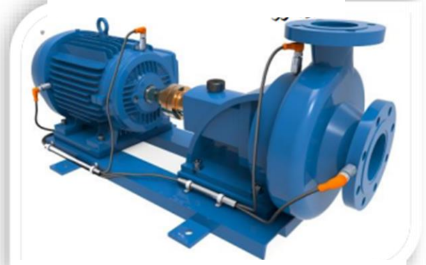
Un ensemble de capteurs de vibrations montées sur une machine
