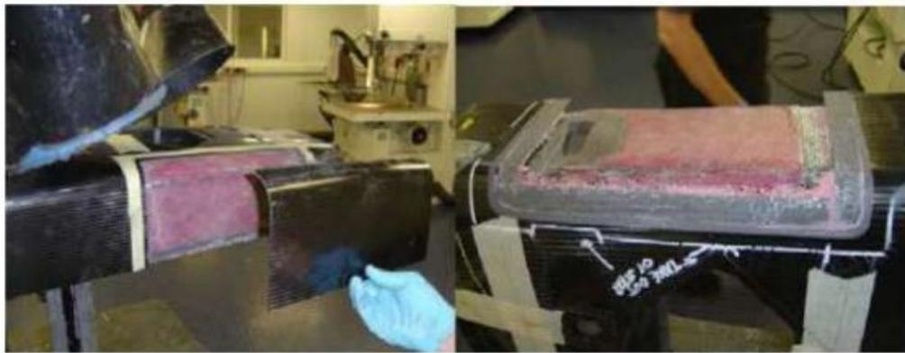
Figure II. 27: Réparation d'un châssis du véhicule F1 par patches composites [39]
