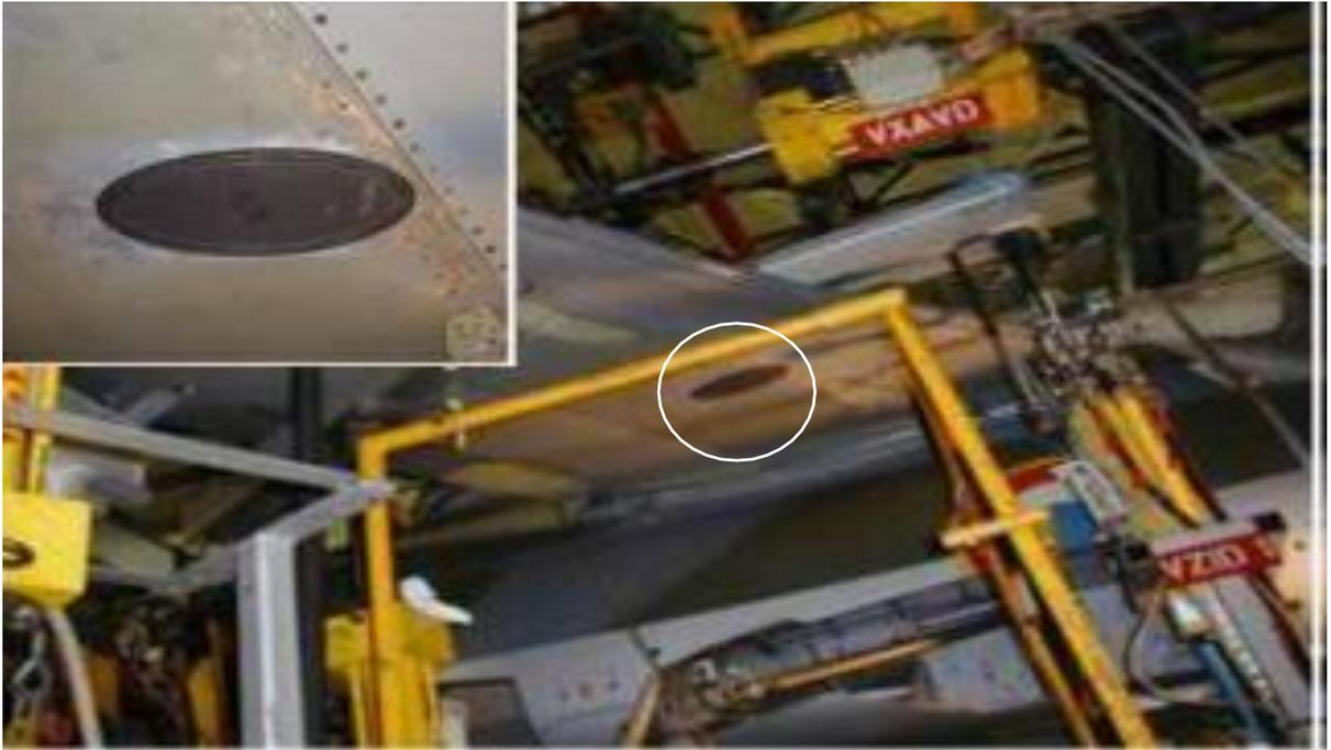
Figure II. 31 : Réparation par collage de patch composite sur une aile d'avion.
