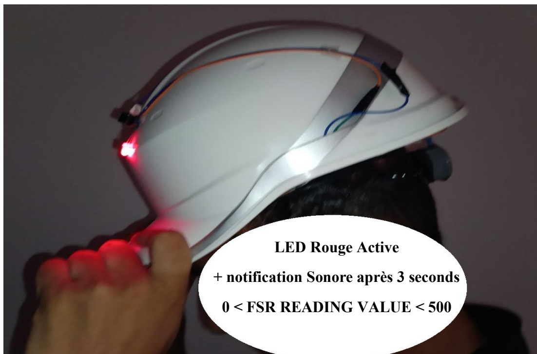
Figure III. 10 : Prototype en cas de détachement du casque
