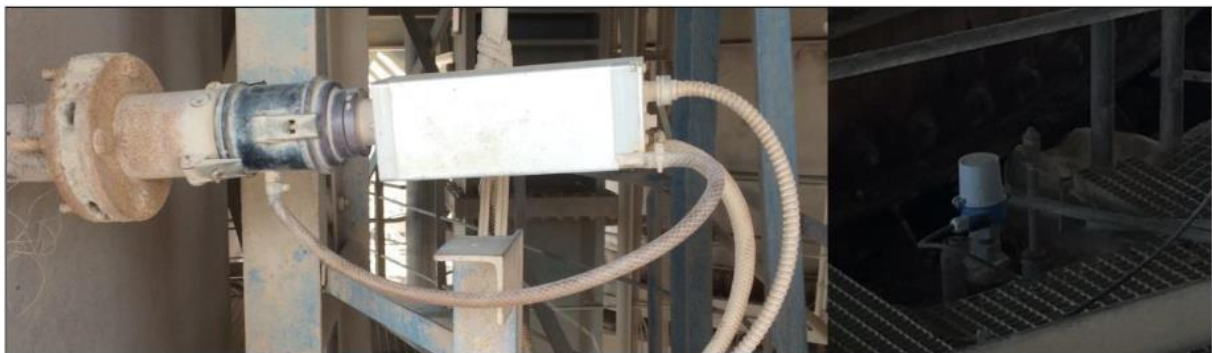
Figure IV 6: Matériel de mesure (à gauche thermocouple, à droite thermometer)
