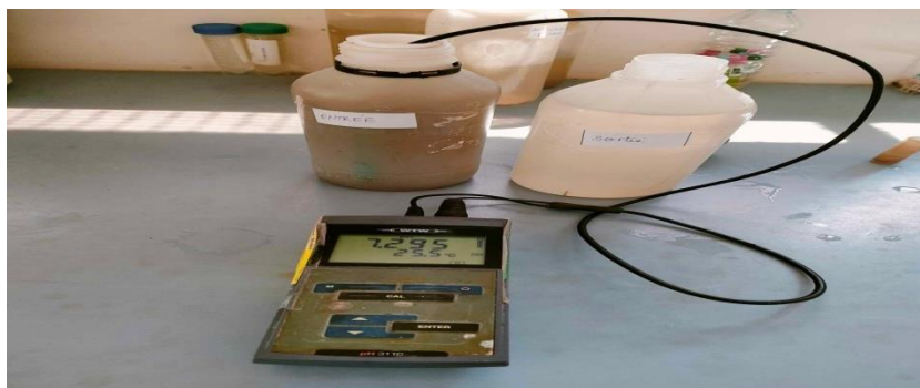
Figure 3.8: Mesure du pH avec le pH-mètre.
