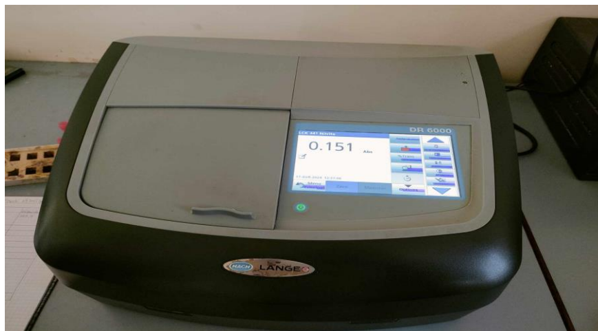
Figure 3.13: Détermination des ortho-phosphates par spectrophotométrie.
