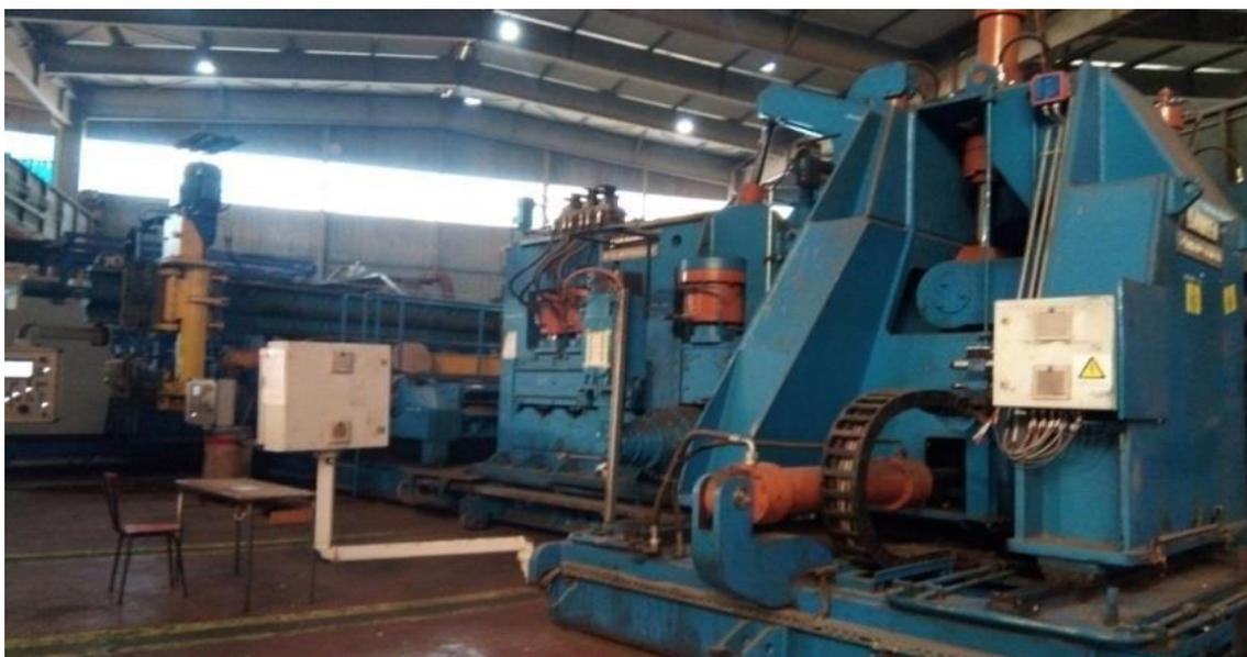
Figure 2.7 : machine à souder (nouvelle)
