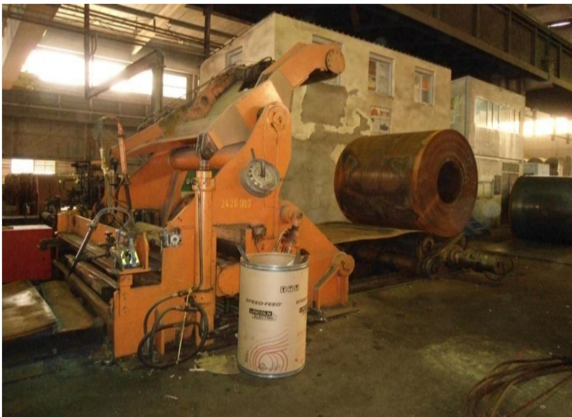
**Figure 2.4 :** *Machine de préparation de bobine*
