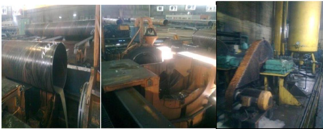
Figure 2.10 : Installation hydrostatique
