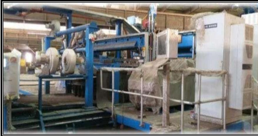
*Figure 34 : Fraiseurs transversaux*
