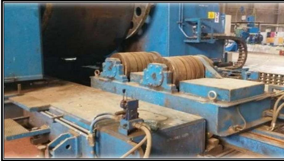
*Figure 29 : Chariot de transport de bobine*
