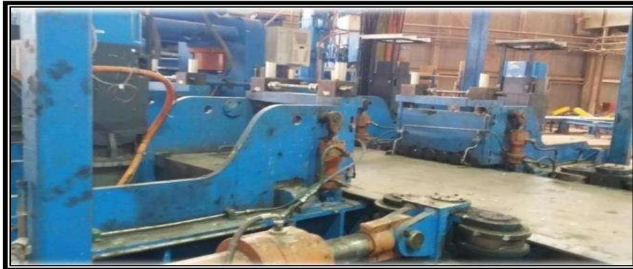
*Figure 37 : Dispositif de fraisages longitudinaux*
