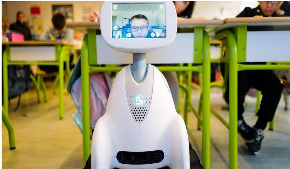
*Figure I-12 Buddy, le robot qui permet de se téléporter en classe*
