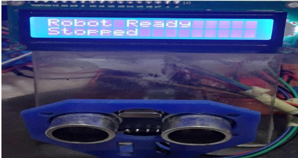
*Figure V -17* Affichage l'état arrêt du robot
