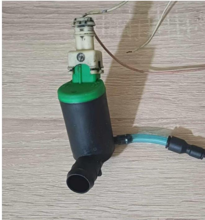
*Figure IV-12* Pompe à eau à membrane 12v
