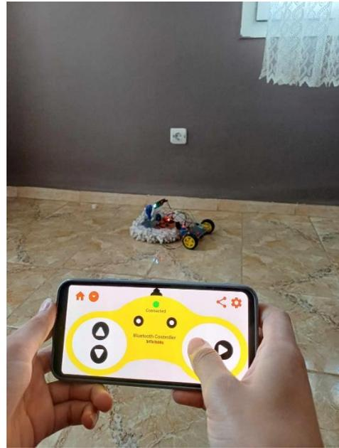
*Figure V-24 Robot tourne a droit avec l'application*
