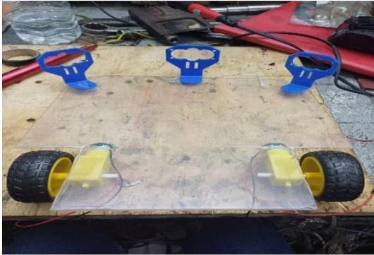
**Montage des roues+moteur+portes capteur**
