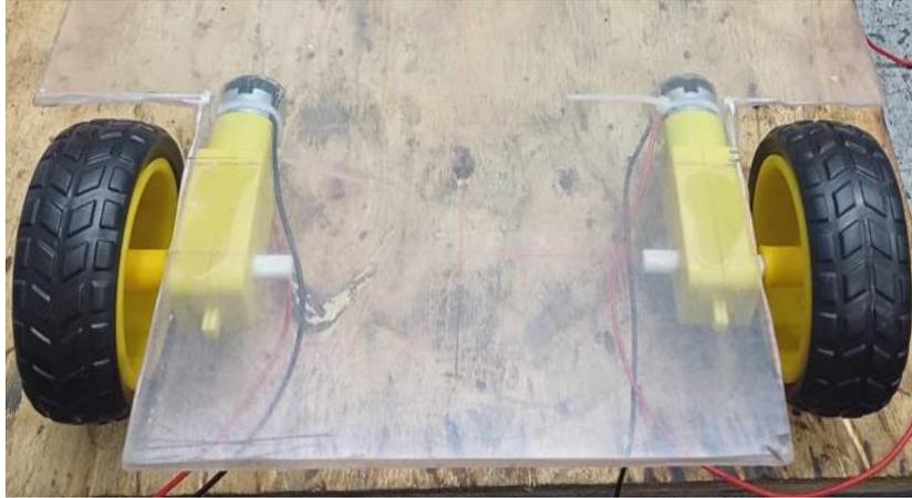
*Figure IV-10* motoréducteur montée sur châssis
