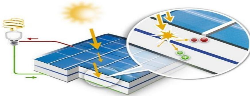
Figure I.8 : Fonctionnement d'une cellule photovoltaïque.
