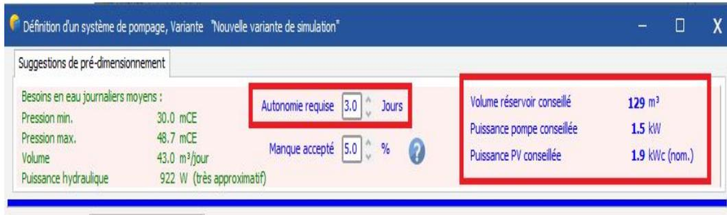
Figure III.35 : Pré-dimensionnement du système de pompage.
