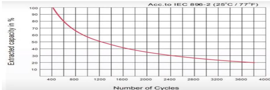
**Figure II.6** : L'effet du DoD sur la durée de vie d'une batterie.
