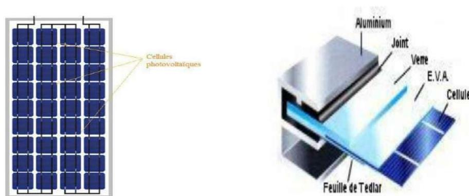
Figure I.20 : Module photovoltaïque.
