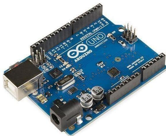
**Figure III.1 : Arduino UNO**
