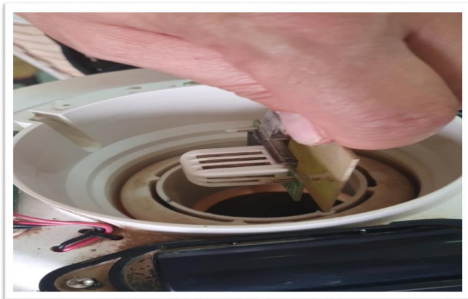
Figure 4.38: Installation de capture de température dans place
