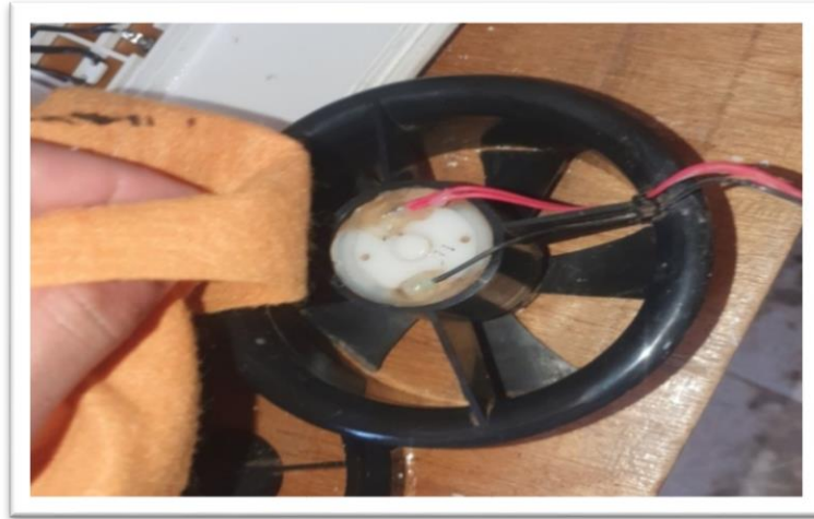
Figure 4.26: Nettoyage de ventilateur
