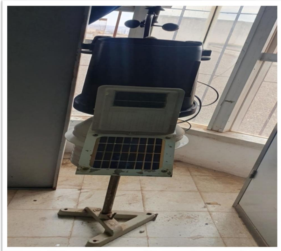
Figure 4.43: Station ventage pro 2 après la maintenance
