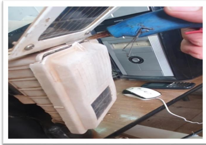
Figure 4.12: Collé les panneaux solaires
