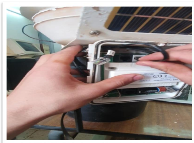
Figure 4.42: Branche les câbles des capteurs dans la Émetteur ISS
