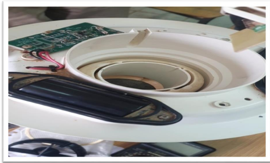
Figure 4.37: Installation du carte électronique dans place
