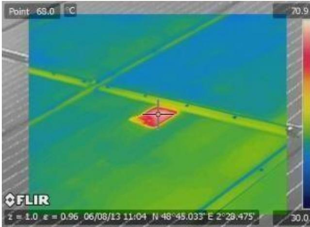
**Figure (III.7) :** Détection de points chauds par thermographie
