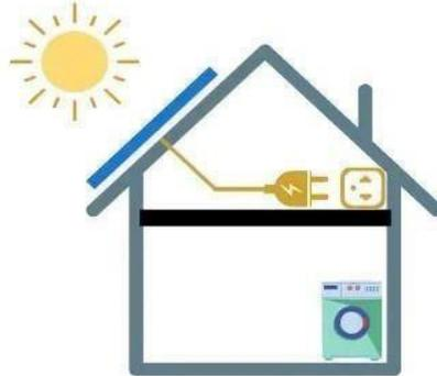
**Figure (I.19) :** *Système photovoltaïque plug&play (éléments caractéristiques)*
