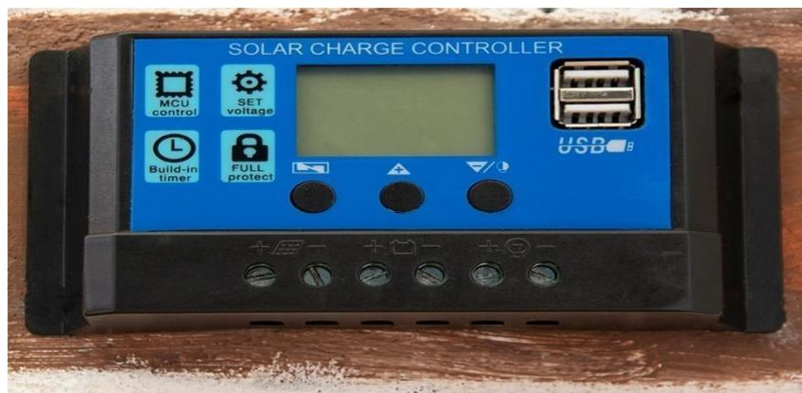
Figure (II.6) : le contrôleur de charge
