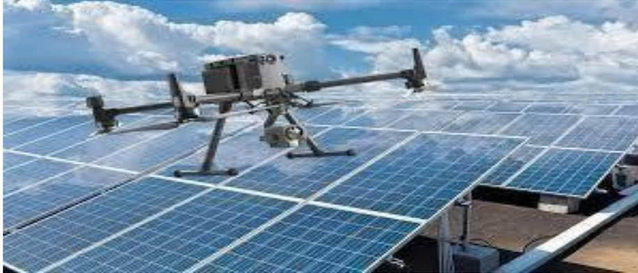
**Figure (II.23) :** *drone thermique.*
