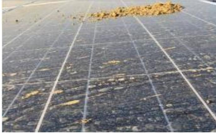
**Figure (III.9) :** Salissure à la surface des modules.
