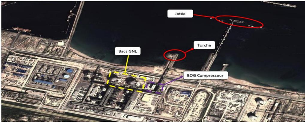
Figure 2-8 : Emplacement des bacs de stockage
