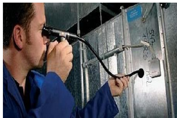
Figure 25 : Le contrôle visuel par la méthode endoscopie
