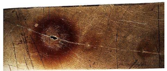
Figure 5 : Corrosion par piqûres sur la paroi d'une cuve en acier inoxydable austénitique Cr18-Ni10
