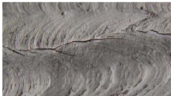
Figure 9 : fragilisation par l'hydrogène de l'acier inoxydable austéno - ferritique z2cnd22 05
