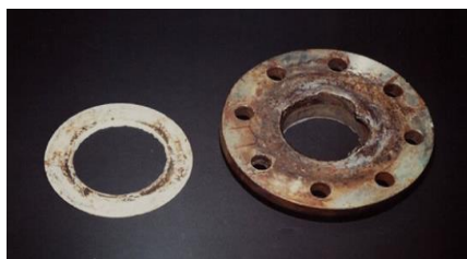
Figure 8 : Corrosion caverneuse d'un acier allié sous un joint
