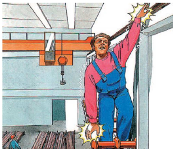
Figure 4.1 : Electrocutation par ligne de contact alimentant un pont roulant
