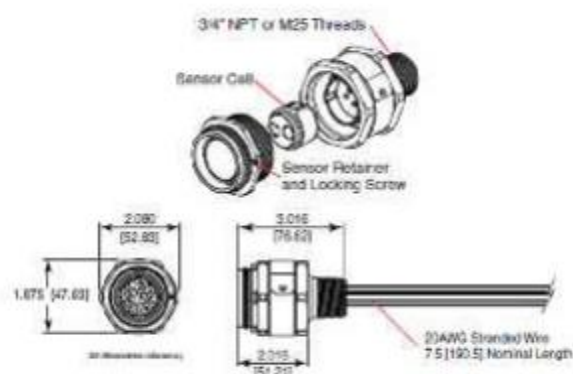
Figure IV.4 : Détecteur de gaz ponctuel IR
