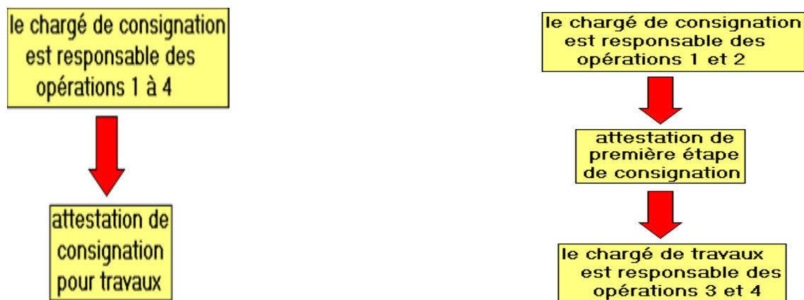
Consignation pour travaux
