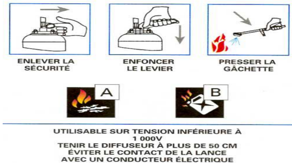
Figure IV.8 : Exemple d'étiquetage d'un extincteur
