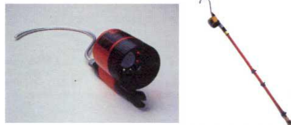
Figure V.18 : Vérificateur et perche pour HT B
