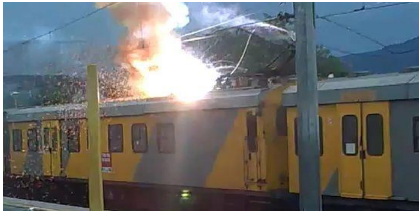
Figure 1.8 : Explosion d'origine électrique
