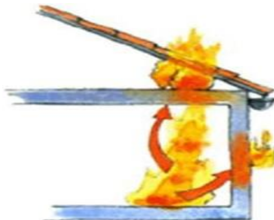
Figure 9: Propagation du feu par conduction [13]
