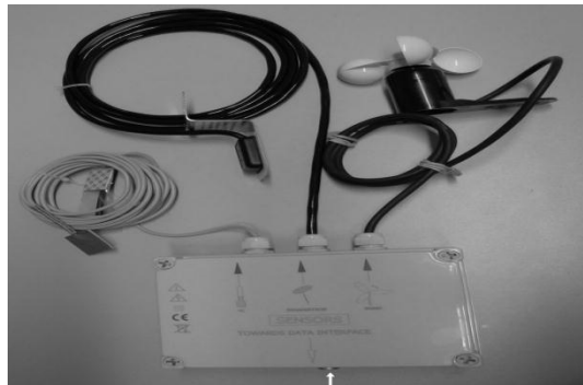
Figure 4.3 Interface capteurs d'AQUI-SOL
