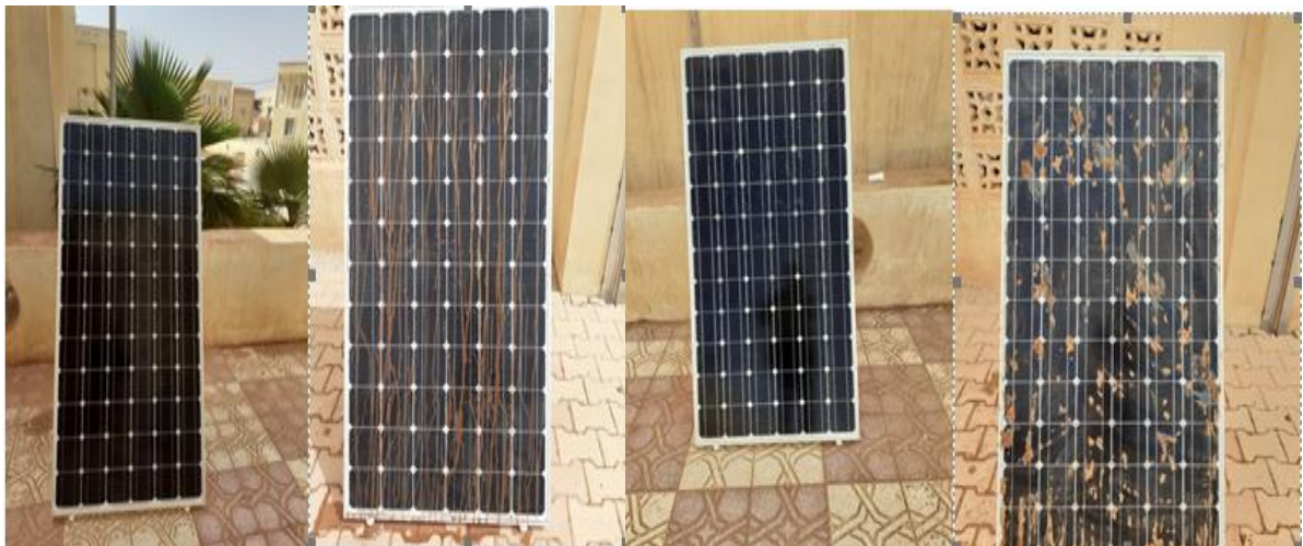
L'essai de 15% de sablage
