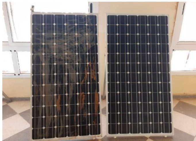
Figure 4.1 Scénario de l'expérience 1 : Comparaison entre un panneau sablé et un autre propre (témoin)
