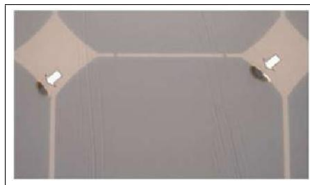
Figure 2.12 Modules présentant des points chauds sur les bords des coins supérieurs [69].
