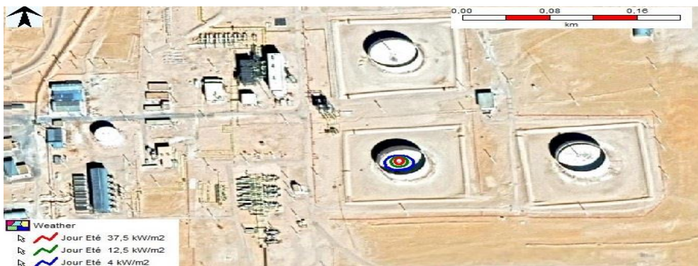
Figure 60 : Effet de jet de feu (petite fuite)
