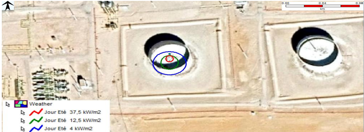
Figure 50 : Les effets de feu de nape immédiat (moyenne fuite)
