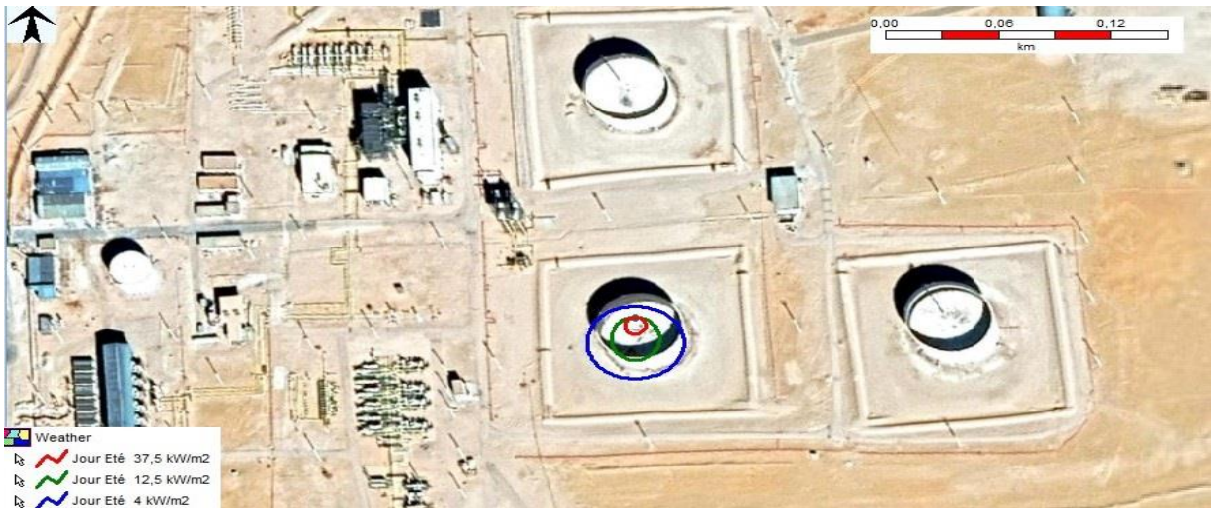
Figure 65 : Les effets de feu de nape retardé (petite fuite)
