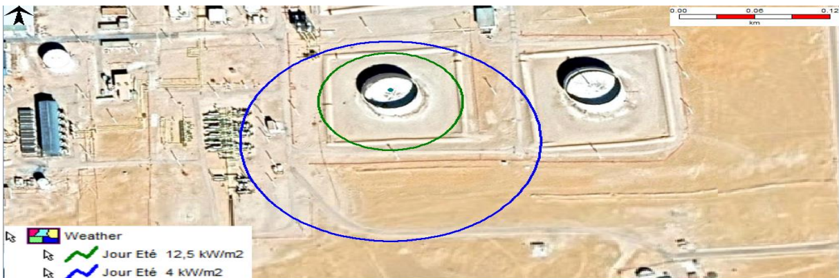
Figure 37 : Les effets de feu de nape immédiat (grande fuite)
