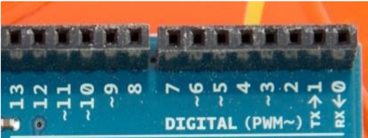
Figure 11 : Broches numériques de la carte Arduino UNO [18].
