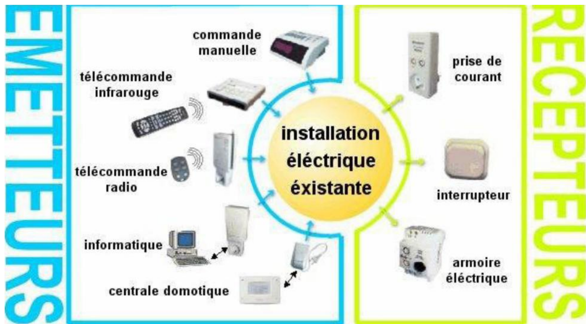
Figure 8 : Présentation de la technologie du courant porteur en ligne [12].
